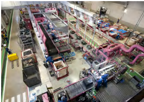
図2 テレビの解体ライン
